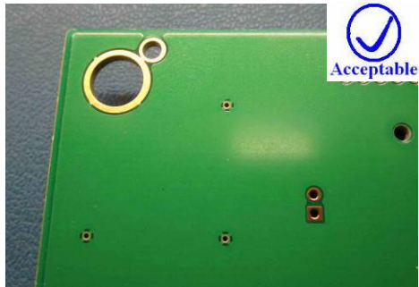
Figures C5-1: No Solder on mounting hole 图 C5-1: 没有多余的焊锡在固定孔
